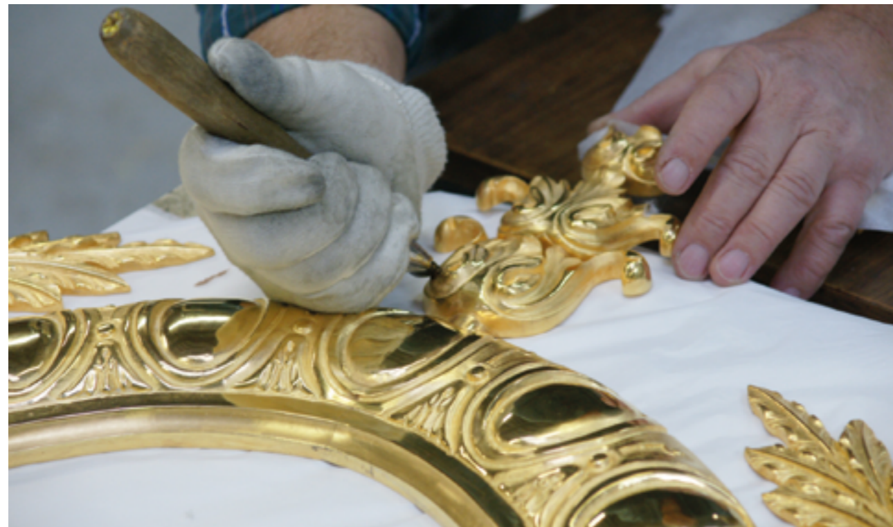
Brunissage manuel à la pierre d'hématite Hematite gemstone hand-burnishing
